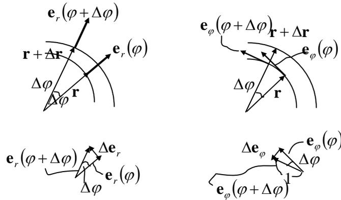
図A.2b  $\mathbf{e}_r$  ベクトルの変化      図A.2c  $\mathbf{e}_\phi$  ベクトルの変化
