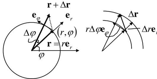
図A.2a 2次元極座標系による速度の表現
